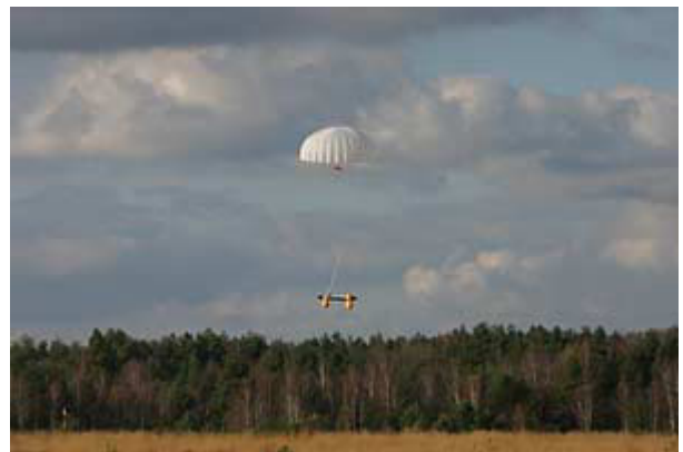
Mit aufgeblasenen Landekissen nähert sich die Drohne dem Boden.
